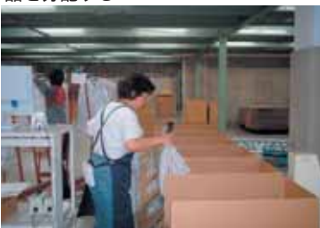
コンベヤ上のケースに種まき式に商品を分配する
