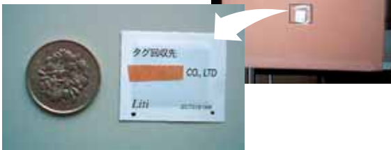
当初はケース単位でICタグを導入。タグは回収している
