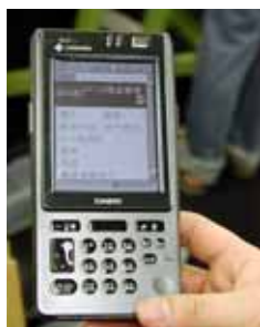
写真右 壁をくり抜いて、物流センターの内部の様子を見せている。スタートトゥデイならではのショーウィンドウだ。 写真上 物流作業に使用する携帯端末。インターネットを通じて在庫や作業の進捗をリアルタイムで共有している。
