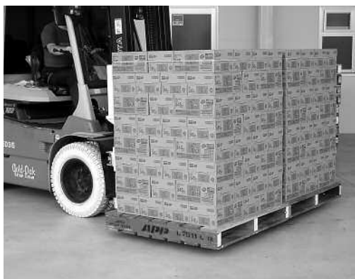
積み込み作業のスピード化を図るため、一度に2枚のパレットを運べるフォークリフトを導入した
