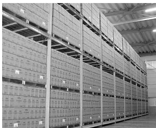
移動ラックにもデッドスペースが生じないよう工夫を凝らした
