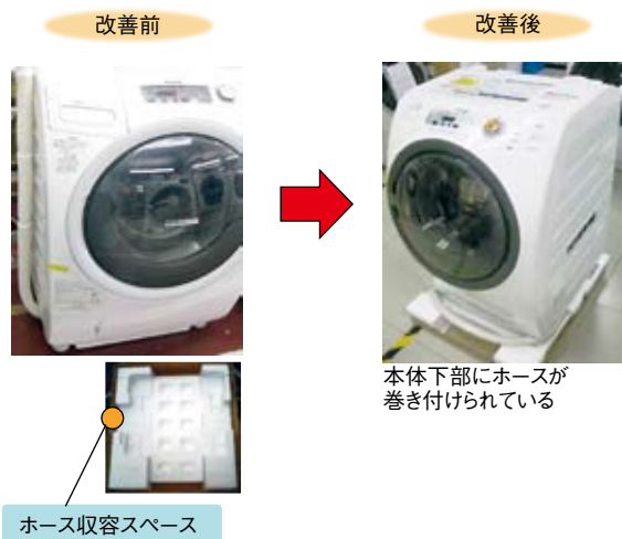
写真1 輸送効率を考慮した製品形状に変更(ドラム式洗濯機)
