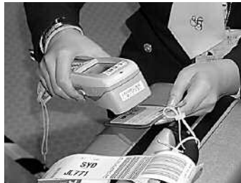
バーコードを読み取る際と変わらない距離でICタグを読んでいる
